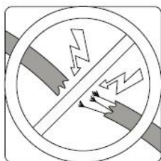
Verificați dacă cablurile sunt deteriorate
