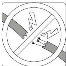
Verificați dacă cablurile sunt deteriorate
